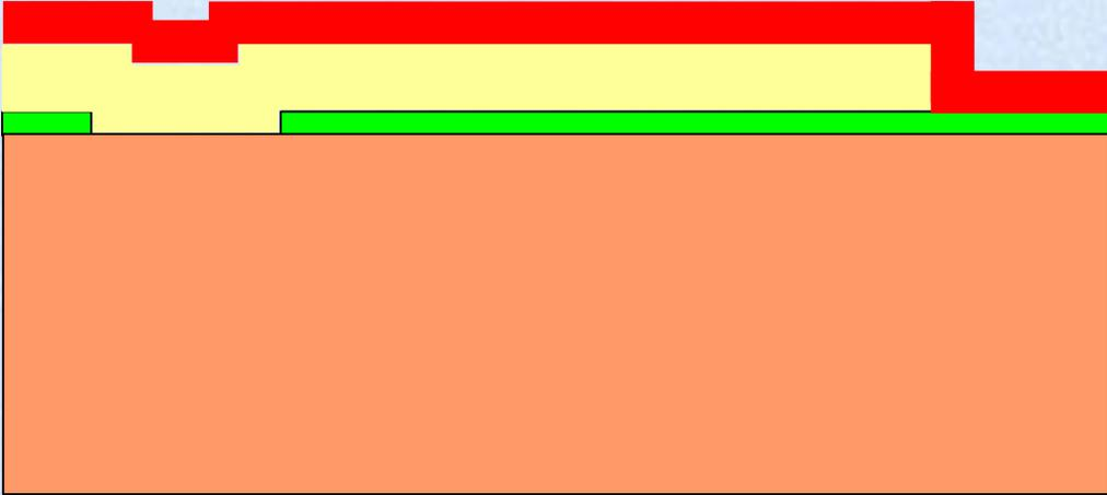
Poly, 2.5  $\mu\text{m}$ , que sirve de electrodo superior y de actuador térmico
