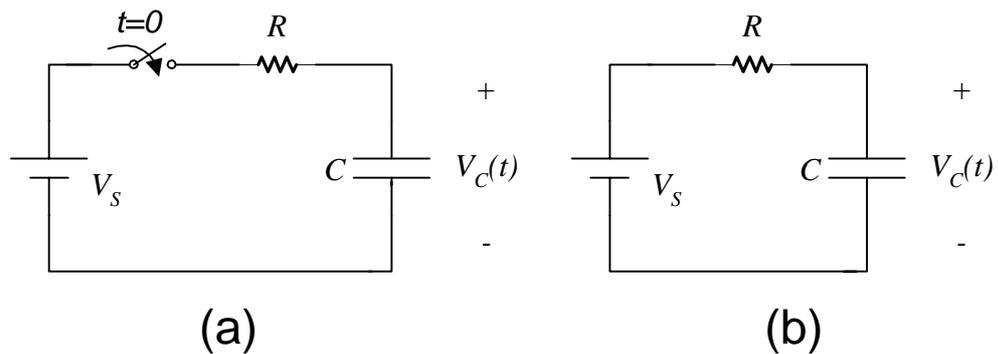
Figura 15. Circuito para calcular la respuesta al escalón.
