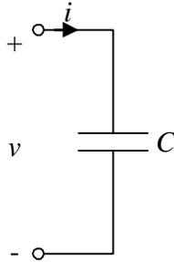
**Figura 3.** Símbolo de un condensador.
