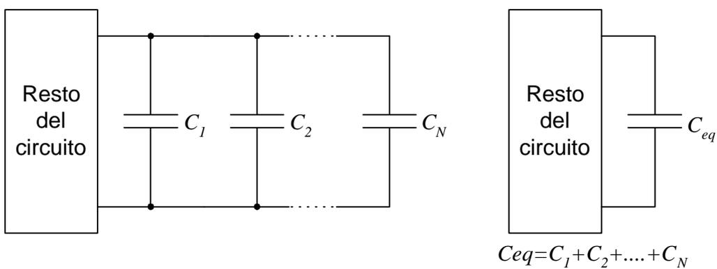
Figura 7. Condensadores en paralelo.
