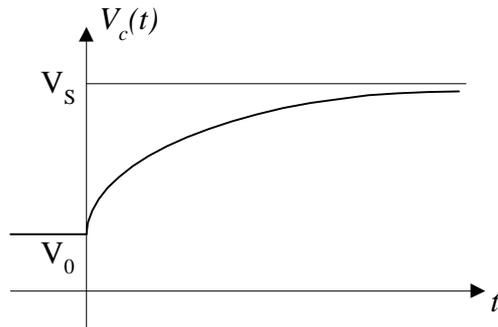
Figura 16. Respuesta al escalón de un circuito RC.
