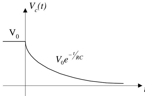
Figura 11. Tensión en el condensador.
